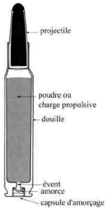
Figure 4 : Représentation schématique d'une cartouche et de ses éléments constitutifs [Herdener et al. , 1997].
